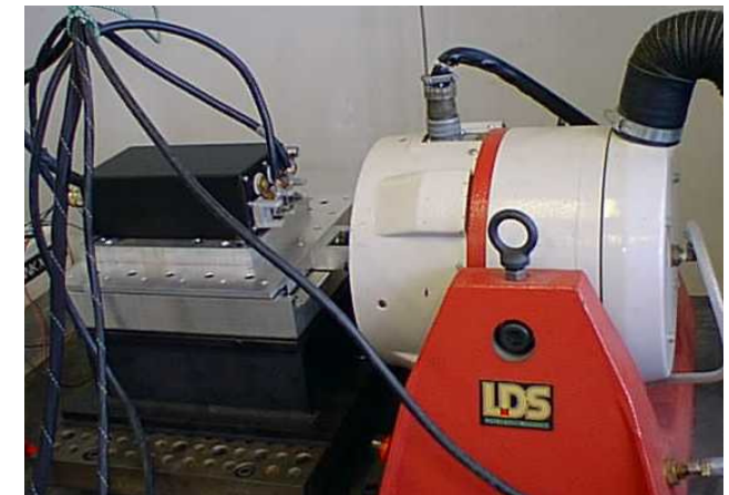
Qualification en vibrations d'un boîtier électronique.
